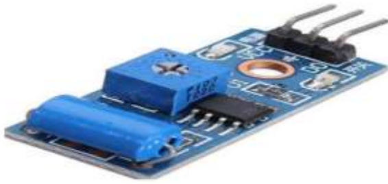
Fig: Vibration sensor
