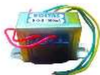
Fig 5.3. Transformer 9 volt 500 amp
